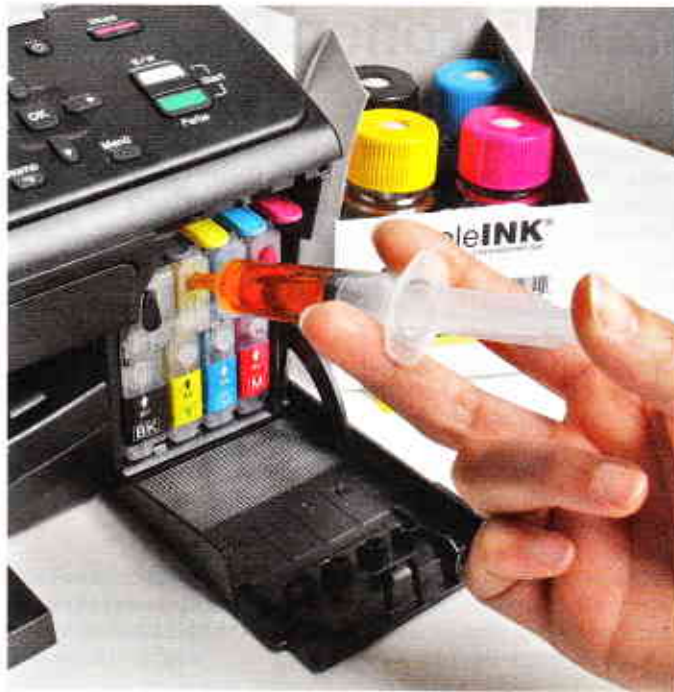
Der Alternativenanbieter Compedo liefert nachfüllbare Ersatzpatronen für Brother-Drucker. Sie lassen sich direkt im Drucker nachbetanken.
