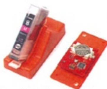
Der „Chip-Redsetter“ setzt den Füllstandsanzähler bei Canon-Patronen wieder auf „voll“.
